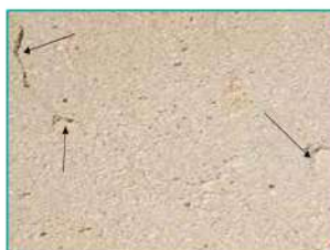
تصویر شماره ۴ ظاهر سنگ به صورت غیریکنواخت و آبله‌رو شده است
